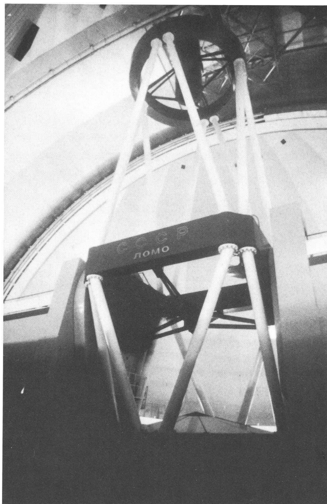
Ansicht des Riesenteleskopes (Höhe 42 m, Durchmesser 6 m, Gewicht 1 200 Tonnen).
