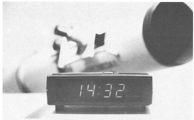
Abb. 2: Digitale Sternuhr mit Quarzbasis.
