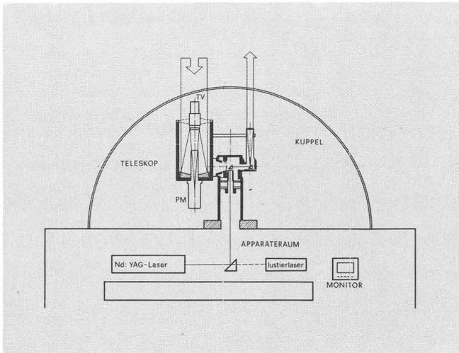
Fig. 4: Schema der Satellitenbeobachtungsstation Zimmerwald.
