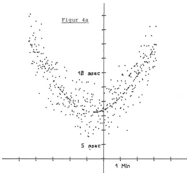
Fig. 4a: Flugzeitmessungen zum Satelliten Starlette ohne Filter.
