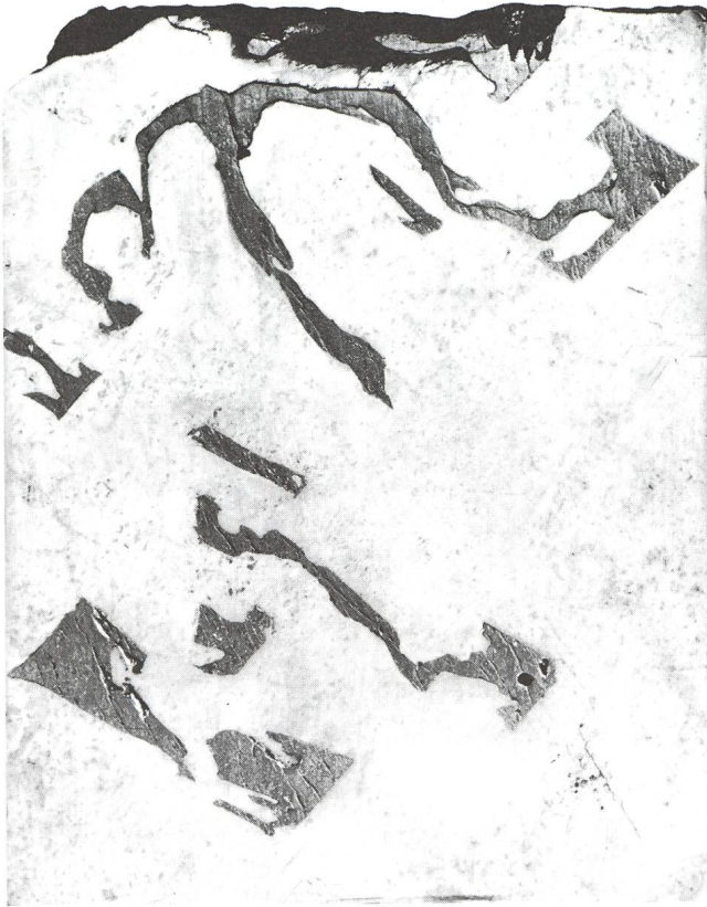
Abb. 7. Der Meteorit von TOMBIGBEE RIVER , Alabama, 1859 gefunden, zeigt in den Primärstrukturen (Schreibersiteinschlüsse) grosse Ähnlichkeit mit TWANNBERG , unterscheidet sich von diesem aber in den Sekundärstrukturen, vor allem im Rekristallisationsgrad. Breite: 5,4 cm.
