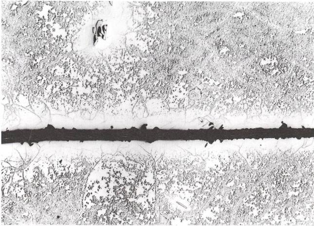
Abb. 5. Gerader, durch terrestrische Korrosion angegriffener Schreibersitkristall neben einem kleinen skelettierten Aggregat der gleichen Zusammensetzung. Die hellen Bereiche um die Schreibersite - phosphor- und nickelarm - zeigen Kamazitkorn Grenzen und vereinzelte Neumannsche Linien. (Bildbreite: 6,8 Millimeter)
