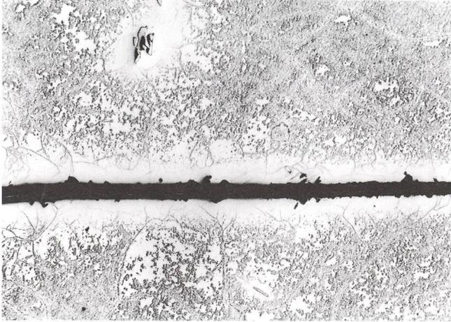
Abb. 5. Gerader, durch terrestrische Korrosion angegriffener Schreibersitkristall neben einem kleinen skelettierten Aggregat der gleichen Zusammensetzung. Die hellen Bereiche um die Schreibersite - phosphor- und nickelarm - zeigen Kamazitkornengrenzen und vereinzelte Neumannsche Linien. (Bildbreite: 6,8 Millimeter)
