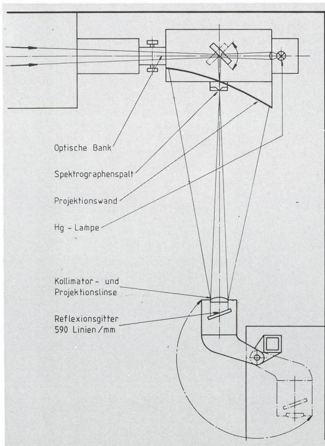
*Bild 1. Das Sonnenlicht wird vom Objektiv, weit links ausserhalb des Bildes, auf den Spektrographenspalt geworfen. Von dort geht das konvergierende Lichtbündel zur Kollimatorlinse und als nun paralleles Bündel zum Reflexionsgitter. Das gestreute Licht des Spaltes geht nochmals durch die selbe Linse, die nun als Projektionslinse dient. Der Spalt wird anschliessend auf der Projektionswand entsprechend den Wellenlängen mehrfach abgebildet.*
