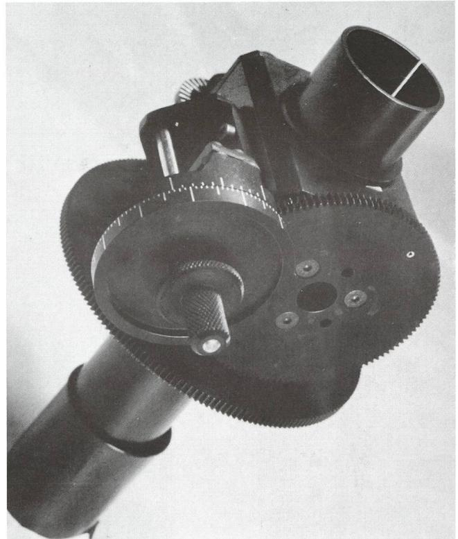
de la mesure de cette inclinaison la valeur de la distance angulaire des composantes d'un couple. De la mesure de l'angle de rotation de la lame lorsque les quatre images forment la figure décrite plus haut, on déduit l'angle de position. Le principe de ce micromètre et de son utilisation ont été exposés en détail par *Jean-Louis Agati et René-Georges Huret* (2).
