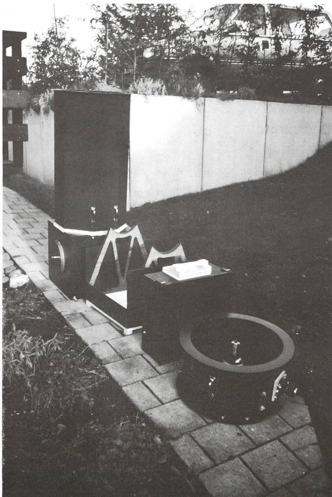
Das zerlegte Teleskop (von vorne nach hinten): Fangspiegelträger, Hauptspiegelkoffer mit geschlossenem Schieber, azimutale Montierung, Tubus. Der Tubus kann nach Entfernen der Handgriffe verkürzt werden, indem der achteckige in den viereckige Teil hineingeschoben wird.
