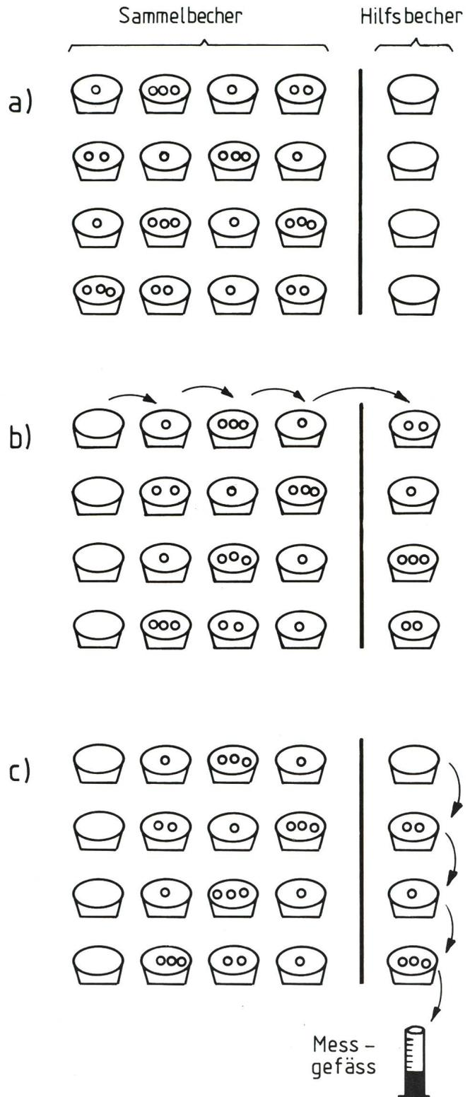
Messzylinder gegossen, und der Inhalt der anderen Becher wandert auch wiederum einen Becher weiter gegen den Rand zum messzylinder (c). Die Messung des Inhaltes des eben gemessenen Regenwassers wird aufgeschrieben, und der Schritt (c) wird wiederholt, bis die gesamte Reihe gemessen ist. Danach wird wie in (b) wieder eine Zeile ausgelesen und mit (c) gemessen. So wird fortgefahren, bis alle Sammelbecher gemessen sind. Nun ist unser Feld wieder für die nächste Messung bereit.
