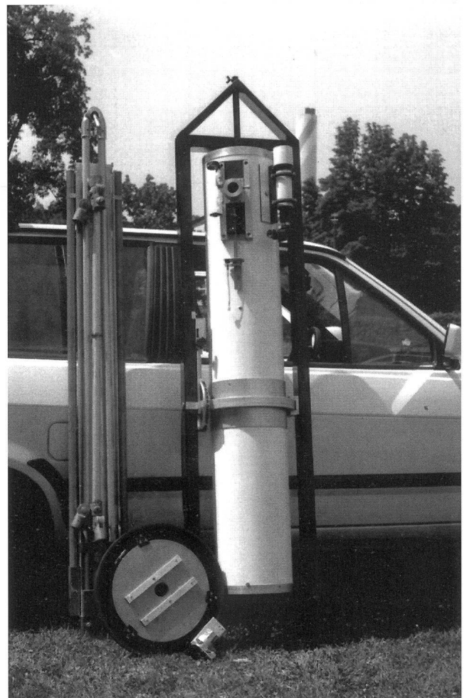
Bild 3: Demontierte Tetraedermontierung. Ersichtlich sind die im U-Profil zum Transport versorgten Rohrstangen, Rahmen mit Rohr und Antriebseinheit.
