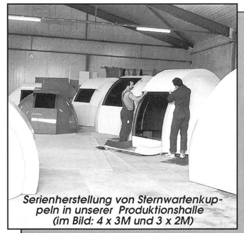
Serienherstellung von Sternwartenkuppeln in unserer Produktionshalle (im Bild: 4 x 3M und 3 x 2M)
