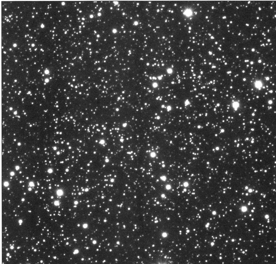
◁ Image du cœur de l'amas globulaire M 55 (NGC 6809) dans le Sagittaire, obtenue le 6 juin avec la «VLT test camera» en une pose de 30 secondes. Cette image brute en lumière rouge couvre un champ de 83" x 83" et la largeur à mi-hauteur des images stellaires n'est que de 0.27". Elle confirme les qualités exceptionnelles combinées du site de Paranal et du premier télescope du VLT. (Photo ESO).
