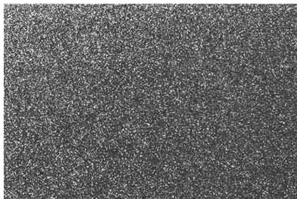
une sensibilité un peu différente de celle des voisins. Cela se traduit par un fond inhomogène. Pour éliminer ce problème, on prend une image du noir, c'est à dire du senseur, qu'on soustrait de la précédente. Ce noir doit avoir le même temps de pose que l'image principale (fig. 4). Après la soustraction (arithmétique), notre nébuleuse est presque parfaite. Certains en restent là et passent au traitement. D'autres, plus puristes, font un flat-field, en français plage de lumière uniforme (PLU).
