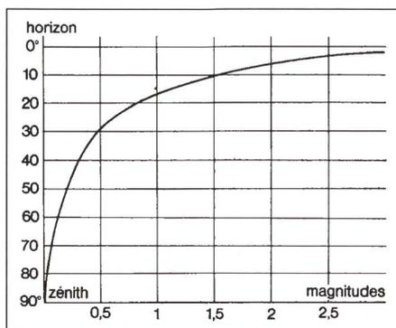
Le graphique ci-dessus donne la relation entre l'absorption en magnitude due à la masse d'air et la hauteur d'observation (en°) par rapport à l'horizon. Il s'agit d'une absorption **relative** par rapport à celle du zénith qui bien entendu n'est pas nulle. Il montre que les observations basses (inférieures à 30°) sont peu satisfaisantes.
