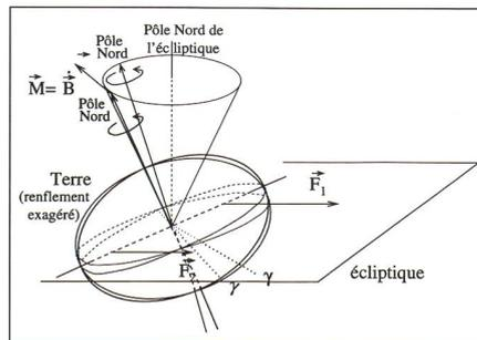
Un élément de matière  $\Delta m = \rho \Delta V$  de la Terre aura un moment cinétique  $\Delta \vec{B} = \rho \Delta V \vec{r} \wedge \vec{v} = \rho \Delta V r^2 \omega \sin \theta \vec{k}$
