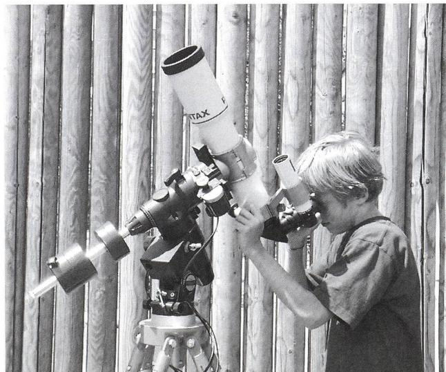
1 1/4"-Adaptionshülse und Okular Pentax XL 21mm (65° Gesichtsfeld). Pentax Rohrschelle BH-75, Celestron Great Polaris Montierung (Deutsche Montierung) mit Polsucher und Gegengewichten. Elektronische Nachführmotoreinheit in Deklination und Rektaszension mit Handsteuerung. Hartholzstativ G3 mit Dreibein und zusätzlichen Beinschnallen für noch bessere Stabilität, Dreipunktfixation und Kegelspitzen!
