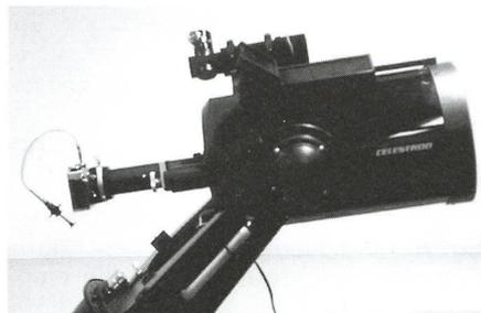
Télescope C8 muni d'un système projectif. Le boîtier est muni d'un déclencheur souple. Devant le télé-convertisseur on distingue le compteur digital de focalisation. Sur le télescope, le système de visée Telrad et derrière la lunette de visée 8x50.
