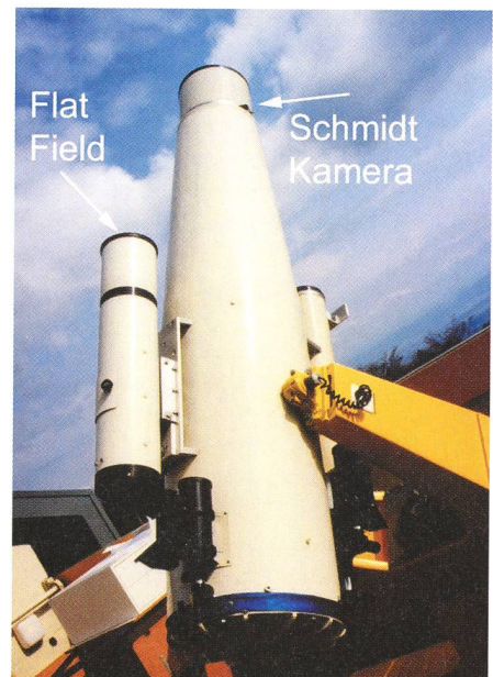
Fig. 11: Grenchenberg Schmidt-Kamera, Brennweite 1000mm, Spiegeldurchmesser 400mm, Öffnung 300mm. Lichtenknecker Flatfield Brennweite 500mm, F/D = 1:3,5.
