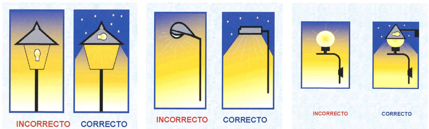
Luminaires: les mauvais et les bons...
