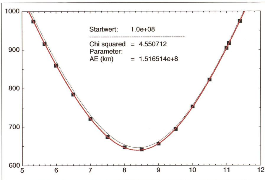
**Fig. 6:** Simulation der Messung von der Winkeldistanz zwischen Venus und Sonne. Im Unterschied zu Graphik 3 wurden die simulierten Messungen mit einem zufälligen Fehler von einer Bogensekunde versehen. Dies entspricht schon eher den praktischen Möglichkeiten eines Amateurastronomen. Die gestrichelte Linie ist der mit dem Startwert berechnete Abstand von der Sonnenmitte.
