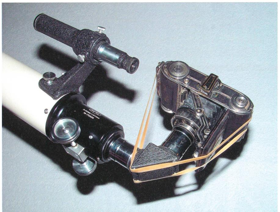
Fig. 1: Le dispositif utilisé pour photographier l'éclipse de 1961. La lunette Perl de 60 mm ainsi que l'appareil de photo Balda Baldina sont d'origine. Les bandes élastiques ont dû être remplacées...
