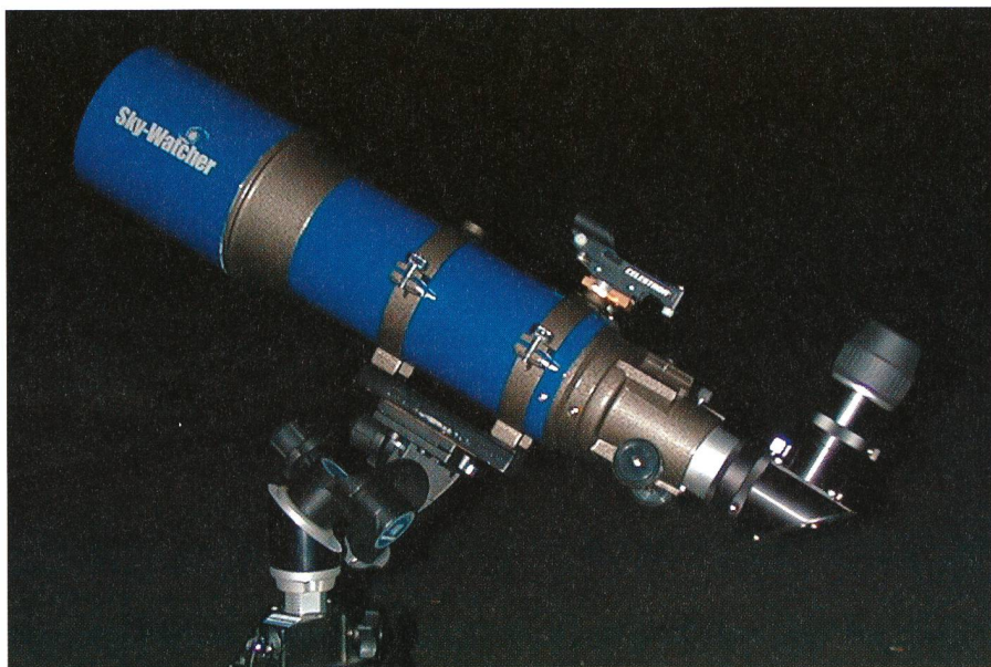
Fig. 2: Antares R120/600 auf Manfrotto Junior Getriebeneigekopf 410, Polhöhenkopf für 47° und Manfrotto Stativ Triman 028.
