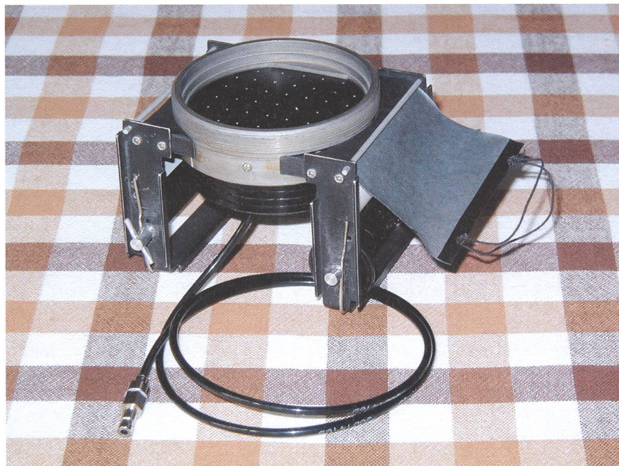
Fig.2: Filmkassette mit Halterung für Mittelformatfilm und Vakuumschlauch zum Ansaugen des Filmes. Nicht sichtbar ist die lichtdichte Abdeckung, welche nach Einsetzen der Filmspule über diese gestülpt wird.
