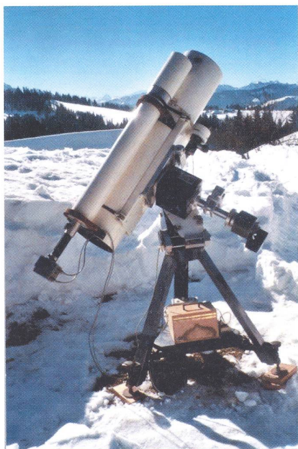
Fig.1: Transportable Maksutov-Kamera 160/500 mit Leitrohr 100/1000. Montierung auf Dreibeinstativ.
