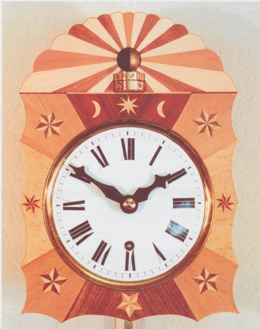
Fig. 1. Die Front mit dem römischen Zifferblatt und der astronomischen Monduhr. Auf der Monduhr können die Mondphasen, der Lauf des Mondes durch den Tierkreis sowie der «obsigende» bzw. der «nidsigende» Mond abgelesen werden. Zu sehen sind ferner die Intarsien, die Sonne, Mond und Sterne darstellen. Die obere Umrandung des Zifferblattes steht für das einem Beobachter abgeflacht erscheinende Himmelsgewölbe; der untere Teil (unter der Trennlinie) ist ein Sinnbild für den durch Berge, Hügel und Täler begrenzten natürlichen Horizont.
