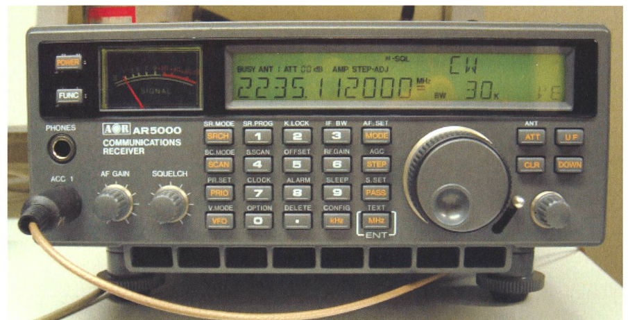
Fig. 2: Kommerzieller Empfänger zum Empfang der Raumsonde auf 2235.10000MHz. Der eingestellte Offset von 12KHz kompensiert die aktuelle Dopplerverschiebung auf Grund der hohen Geschwindigkeit von SMART-1.
