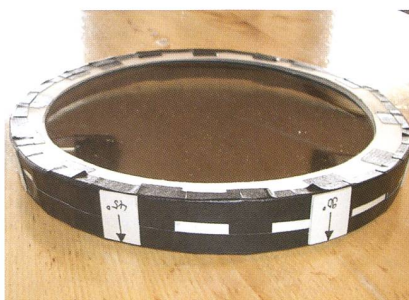
Der selbst hergestellte Polarisationsfilter, welcher während den Messungen vorne auf das Celestron Teleskop gesetzt wurde. Es sind noch die Winkelmarken zu erkennen, nach welchen der Filter jeweils ausgerichtet werden musste.
