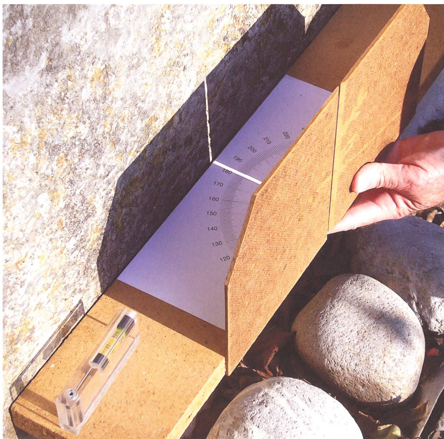
Figur 8: Winkelmessgerät zum Bestimmen der Richtung des Gnomons. Dazu müssen der Winkel beim besonnenen Streifen und die genaue Uhrzeit abgelesen werden.
