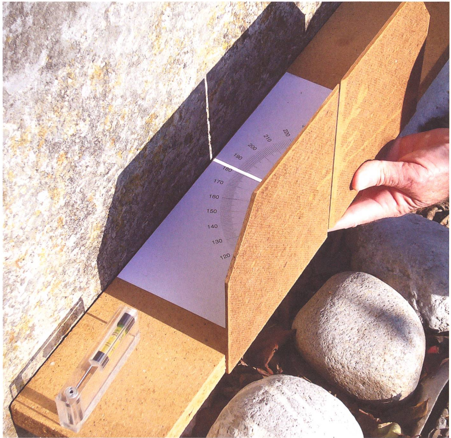
Figur 8: Winkelmessgerät zum Bestimmen der Richtung des Gnomons. Dazu müssen der Winkel beim besonnenen Streifen und die genaue Uhrzeit abgelesen werden.
