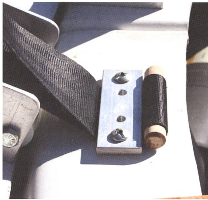
Abbildung 5: Reibungsbremse gegen den Restdurchschlupf der Gurte.
