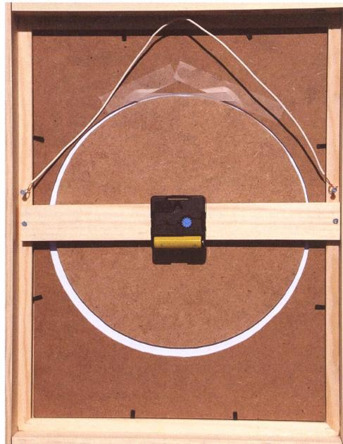
*Die drehbare Sternkarte von hinten. Holzleisten an den Rahmenrändern vergrössern den Wandabstand, damit das Uhrwerk Platz hat, welches das runde Sternfeld antreibt und über einen Holzsteg mit dem Bild verbunden ist. Die weisse Schnur erleichtert das Aufhängen. Auf der Oberseite wurde etwas gleitender Kunststoff befestigt, damit die Sternscheibe einen gleichmässigen Abstand zum Horizontblatt hat. (Foto: Thomas Knoblauch)*
