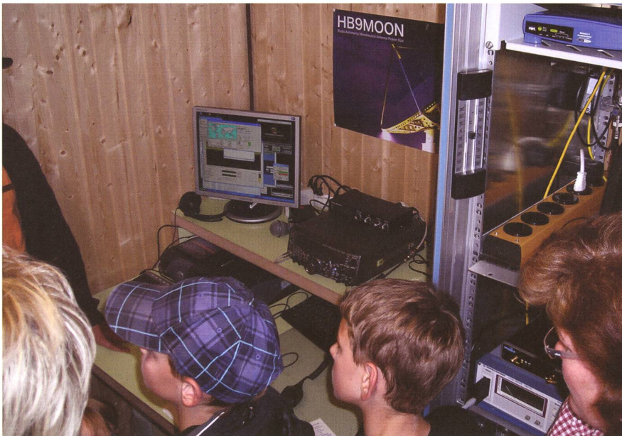
Die Kinder aus Ermenswil und Umgebung hören gespannt den Erläuterungen des lizenzierten Leiters, bevor sie selbst über den Mond sprechen dürfen. Links der Computermonitor zur Steuerung des Teleskops, in der Mitte der Sender-Empfänger und rechts der Elektronikschrank mit dem Leistungs-Sender und der Elektronik für die Internetanbindung. (Foto: Christian Monstein)
