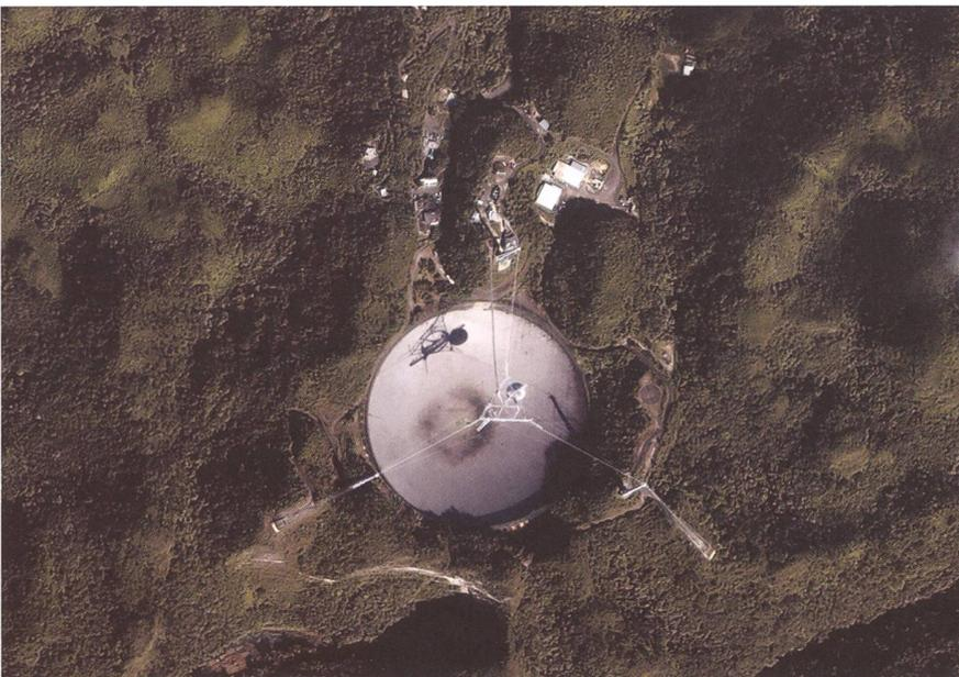
Das riesige Radioteleskop von Arecibo in Puerto Rico hat mit 305m einen derart grossen Empfangsspiegel, dass es sogar aus einer Satellitenumlaufbahn problemlos erkennbar ist. Ein Empfänger im Fokus des Instruments nimmt parallel zu anderen radioastronomischen Projekten das Rauschen aus dem All für das SETI-Projekt auf. (Bild: USGS/NASA)
