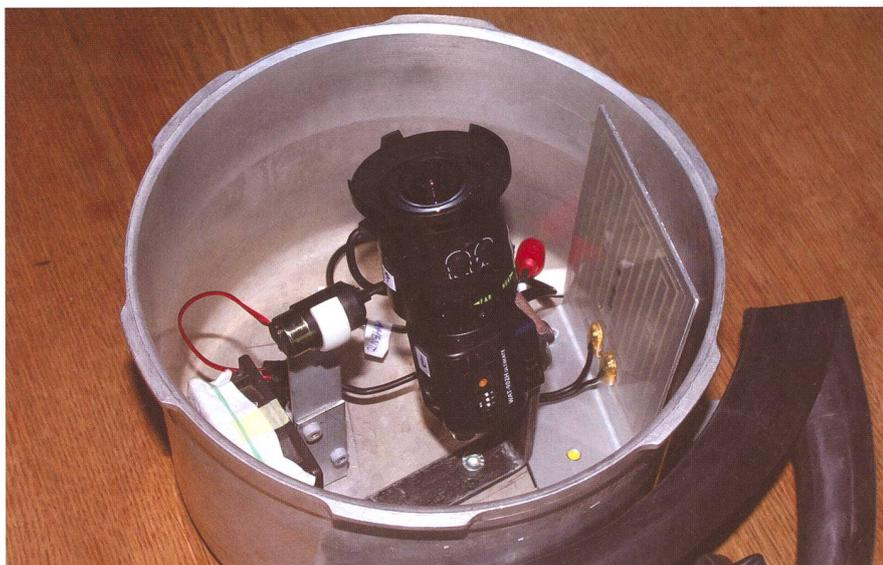
*L'apparecchiatura alloggiata nella pentola; la videocamera, la termoresistenza (sulla destra), la ventola (in basso a sinistra), il motorino (a sinistra della videocamera). Mancano i sensori di umidità, di temperatura, la copertura in alluminio, i granuli dissecanti e i cablaggi.*
