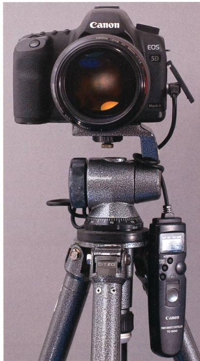
*Digitale Spiegelreflexkamera mit lichtstarkem Objektiv und Kabelauslöser, montiert auf einem Fotostativ. Mit dieser Kombination wurde die auf Seite 26 zu sehende Aufnahme gewonnen. Nicht abgebildet ist die Störlichtblende sowie der Weichzeichner-Filter.*
