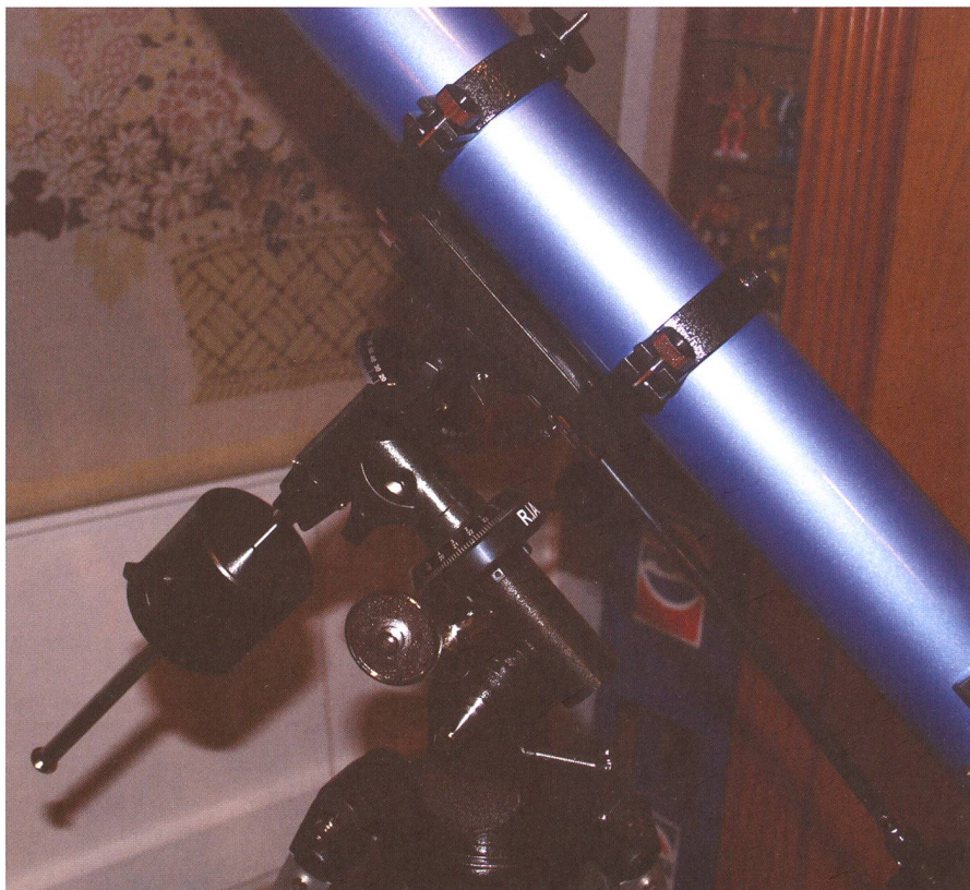
Die EQ-2-Montierung, die mit dem angesetzten 70/900mm-Tubus eine eben noch akzeptable visuelle Stabilität bietet. (Bild: Christian Leu)
