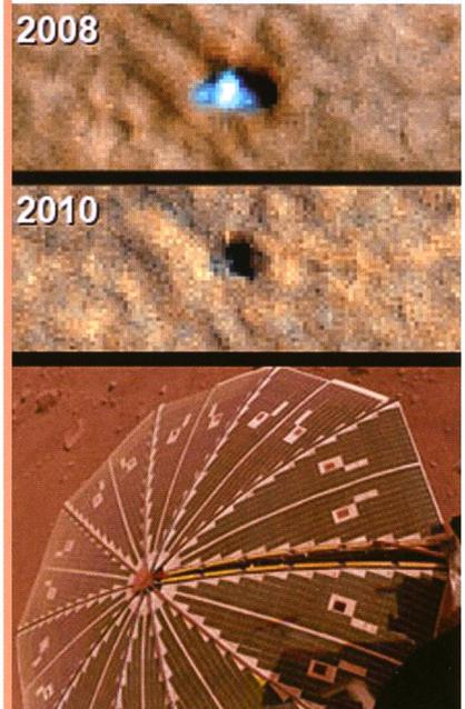
Während mehr als 200 Flüge von Orbiter Mars-Odyssey über der Landungsstelle horchte die Sonde nach Funksignalen von Phönix. Aber jeder Horchversuch endete ergebnislos. Nach den jüngsten vom Orbiter geschossenen Aufnahmen fielen die Solarpanele von Phönix durch die durch die Vereisung durch Kohlendioxid verursachte Verformung aus. «Wir haben keine Hoffnungen mehr», sagte der Vertreter der NASA, PETER SMITH. (aba)
