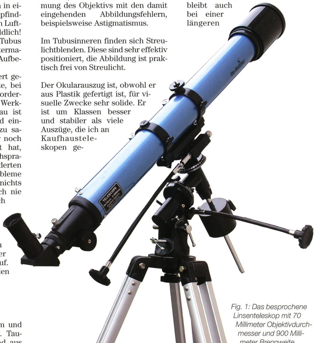
Fig. 1: Das besprochene Linsenteleskop mit 70 Millimeter Objektivdurchmesser und 900 Millimeter Brennweite.
