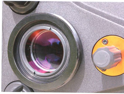
Abb. 4: Die HD-Linse sitzt sehr nahe beim Anschlussgewinde, wie im Bild links zu sehen ist. Die rechte Aufnahme zeigt einen Blick ins Blendenrohr mit dem Sekundärspiegel. (Bild: Jan de Lignie)
