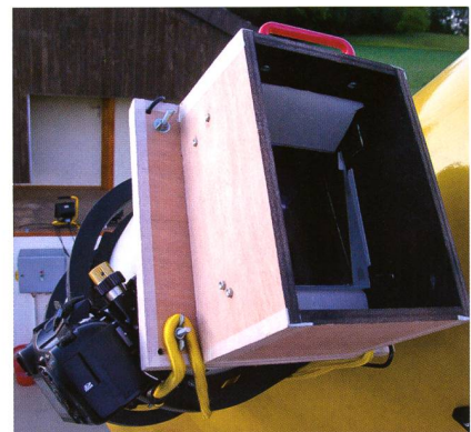
Das Objektivprisma aus Flintglas ist am Meade SNB Teleskop mit Gummiseilen befestigt und in Nord-Süd-Richtung ausgerichtet. (Foto: Sascha Gilli)
