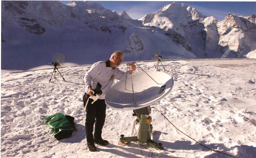
Abbildung 2: 120 cm Parabolspiegel montiert auf einer parallaktischen Eigenbau-Montierung. Das Instrument kann ferngesteuert werden aus dem Observatoriumszimmer im Hotel Diavolezza. Der Autor prüft gerade den Doppelquad Dipol im Fokus der Antenne. Im Hintergrund zwei Antennen des solaren Radiointerferometers bei 13 cm Wellenlänge. (Bild: Heidi Hostettler, ETH Zürich)
