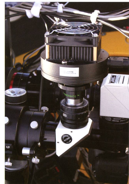
Abbildung 4: Die Astrolumina Alccd 9 Kamera mit vorgeschalteter Barlowlinse im nachgerüsteten Baader Okularstutzen des Lunt Ca II K Diagonalmoduls.
