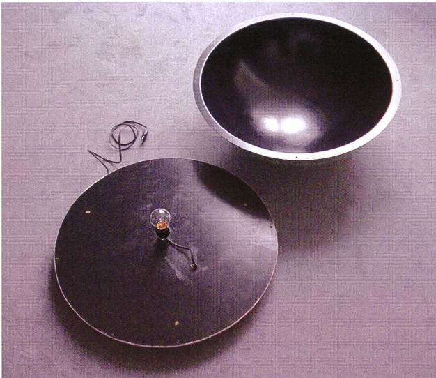
Abbildung 4: Eine 25-Watt-Glühbirne dient als Spiegelheizung. (Foto: Peter C. Slansky)
