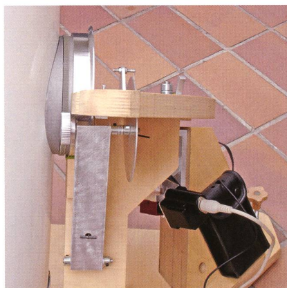
Abbildung 11: Das Deklinationsgetriebe i = 1:4 .
