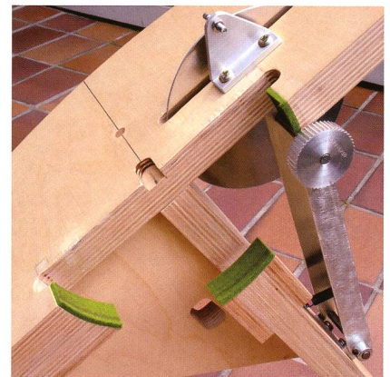
Abbildung 8: Die Filzlagerung der Höhenräder und die Schwinne mit Zahnriemenscheibe und Zugfeder.
