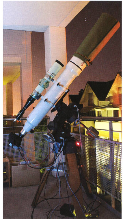
Abbildung 2: Der NA140 in astrofotografischer Montur mit Pentax 75SDHF als Leitrohr auf AOK WAM300-Montierung; so entstand Abbildung 8. (Bild: Jan de Ligne)
