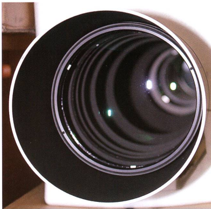
Abbildungen 3 und 4 (unten): Korrekt eingebaute Blenden...
