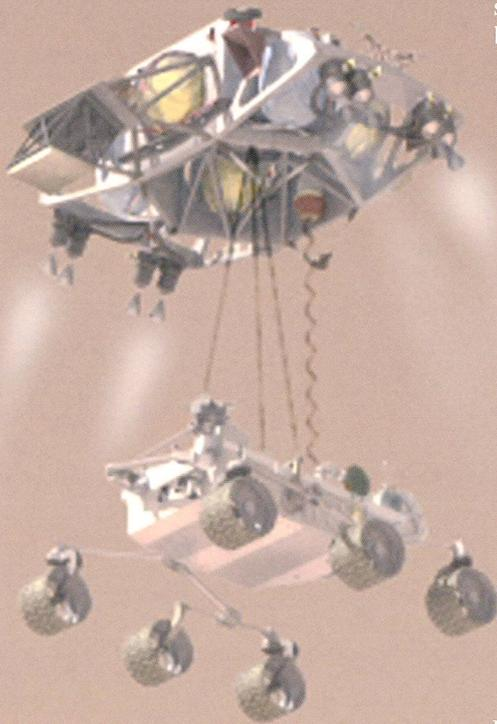
Abbildung 8: Curiosity wird „am Seil herunter gelassen“. Mit einer neuartigen Technologie soll der fast eine Tonne schwere Marslander im kommenden August im Gale Krater auf Mars landen. Dieses Verfahren soll später auch für die Gemeinschaft Mission ExoMars der ESA und NASA zur Landung zweier Marsfahrzeuge angewendet werden. (Bild: NASA-JPL/ Archiv Schmidt)
