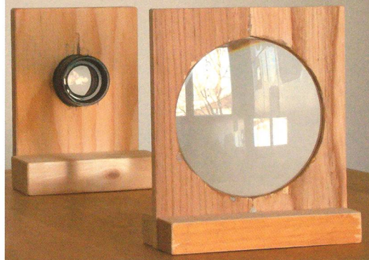
Abbildung 11 und 12: Eine Sammellinse (das Fernrohr-Objektiv) erzeugt auf einem weissen Karton das umgekehrte Bild eines Fensters. Nach Entfernen des Kartons bleibt dieses reelle Zwischenbild im Raum erhalten. Mit dem Okular betrachtet man das Zwischenbild von hinten her wie mit einer Lupe. Wir sehen ein virtuelles Bild. (Bilder: Erich Laager)
