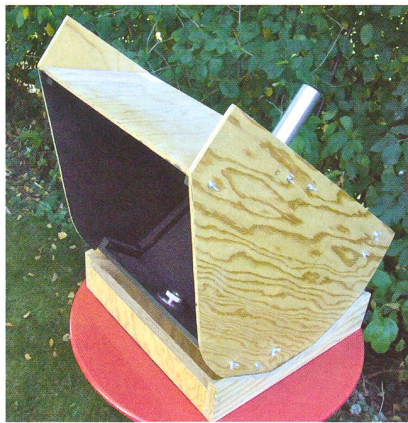
Abbildung 5: Das Solarscope als Holzmodell. Das Original besteht aus stabilem Karton; die optischen Bauteile wurden diesem Bausatz entnommen. Das Aluminiumrohr enthält das Objektiv, welches das Sonnenbild auf einen kleinen Kugelspiegel wirft. Dieser befindet sich in einer Metallfassung (unten links im Bild), welche zum Fokussieren mit einem Schraubgewinde verstellt werden kann. Das Sonnenbild erscheint gross auf der Innenseite der Vorderwand.
