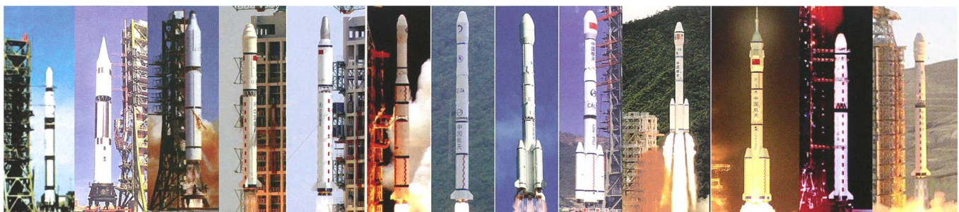
Abbildung 3: Die chinesische Trägerraketenfamilie CZ («Chang Zheng» = Langer Marsch) in Reih und Glied, hier von links nach rechts: CZ-1, FB-1, CZ-2, CZ-2C, CZ-2D, CZ-3, CZ-3A, CZ-3B, CZ-3C, CZ-2E, CZ-2F, CZ-4A, CZ-4B (Bild: Chinese Internet/Archiv Schmidt)
