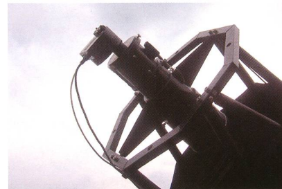
Figure 2: La caméra digitale est montée sur la partie frontale. (Image: zvg)
