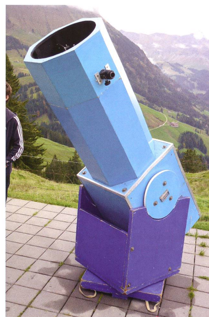
Abbildung 2: Der «blaue Riese», der 45er-Dobson der Astronomischen Jugendgruppe Bern. (Bild: Roman Kläger)
