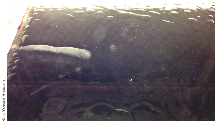
Abbildung 2: Typische Spur eines Alpha-Teilchens (links im Bild). Da Alpha-Teilchen um ein Vielfaches schwerer sind als Beta-Teilchen oder Myonen, erzeugen sie eine viel dickere Spur.
